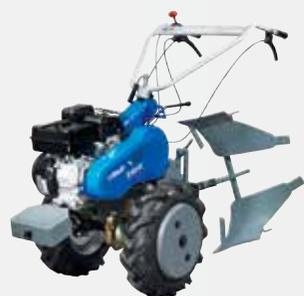
ST 4672 CF équipée en labour : brabant 1/2 tour, roues 500x10, masses, contrepoids, moyeux à effet différentiel.
