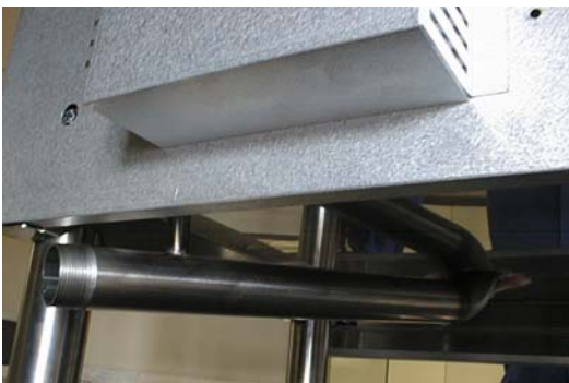
Evacuation four Oven drainage Afvoer van de oven
