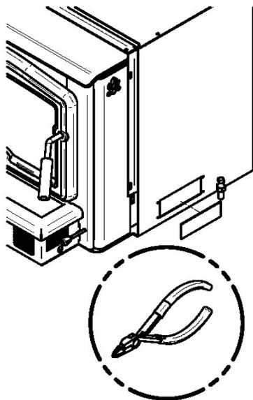
1- À l'aide de pinces, retirez la plaque métallique rectangulaire (A) retenue par les micro-joints afin de dégager l'ouverture prévue pour la prise d'air extérieur.
