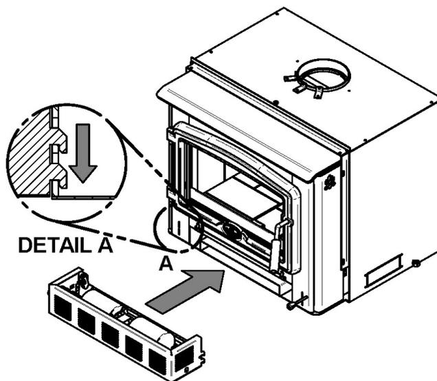
Pour assembler la tablette, ouvrez la porte au maximum afin de favoriser l'installation. Poussez la tablette vers le bas afin qu'elle se loge dans les attaches situées sous la porte de chargement (voir détail A). Refermez la porte lorsque terminé.
