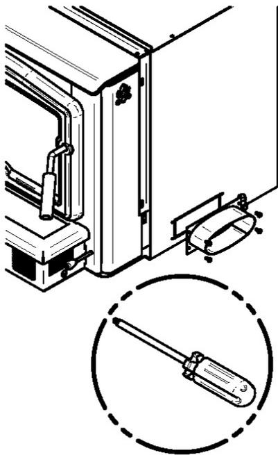
2- Installez l'adaptateur de prise d'air extérieur (B) à l'aide de 4 vis (C).
