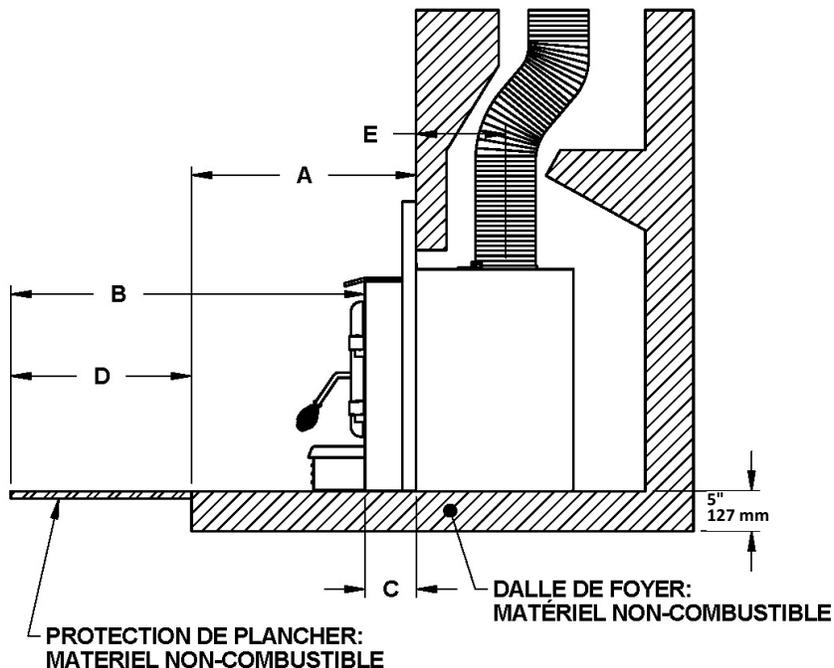
L'utilisation de la valeur R est pratique lorsque plus d'un matériau est utilisé dans la protection de plancher installé devant l'extension de l'âtre pour couvrir la surface combustible. En effet, les valeurs R sont additifs, tandis que les valeurs K ne le sont pas.
