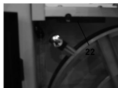
Les contacteurs supérieur (21) et inférieur (22) coupent l'alimentation électrique du moteur lorsque les portes sont ouvertes, volontairement ou de façon accidentelle. Les portes supérieure et inférieure doivent impérativement être fermées pour que la machine puisse démarrer.
