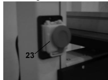
L'interrupteur marche/arrêt de la machine est équipé d'un couvercle "arrêt coup de poing" d'urgence (23). La fermeture de ce couvercle par une simple frappe provoque l'arrêt instantané de la machine.
