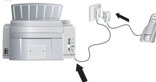
Vous pouvez raccorder d'autres appareils à d'autres prises téléphoniques d'une même ligne, même si celles-ci se trouvent dans des pièces différentes.
