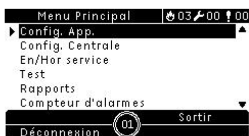
Figure 22 : Menu principal du niveau Installateur
