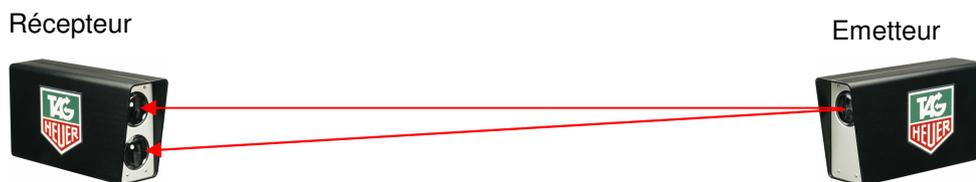
Dans des conditions normales d'utilisation, la photocellule HL 2-35 fonctionne parfaitement avec une distance entre émetteur et récepteur de 40 mètres en position LOW et 80 mètres en position HIGH.
