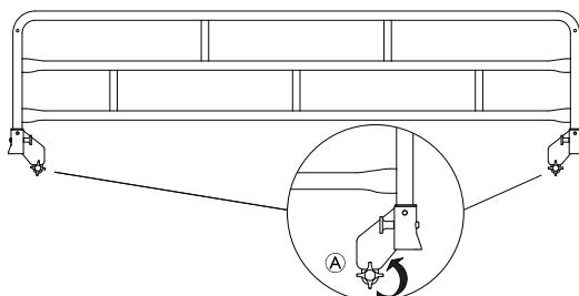
Desserrez les molettes **A** sur les deux attaches de la barrière latérale.
