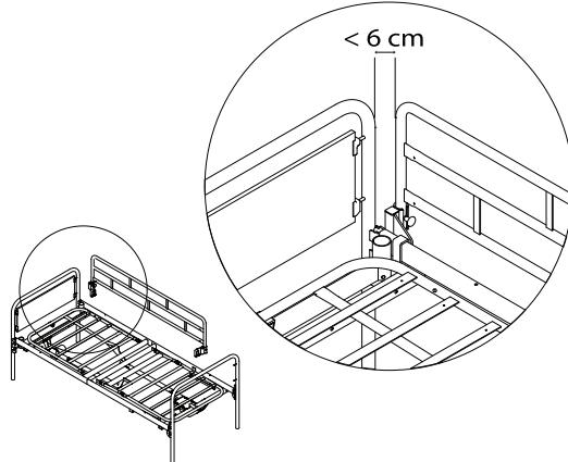
Faites descendre la barrière latérale dans l'attache du pied avant et serrez à l'aide de la molette.
