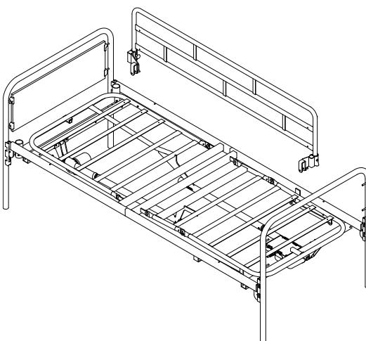
Placez la barrière latérale sur le châssis à proximité de l'extrémité avant du lit.
