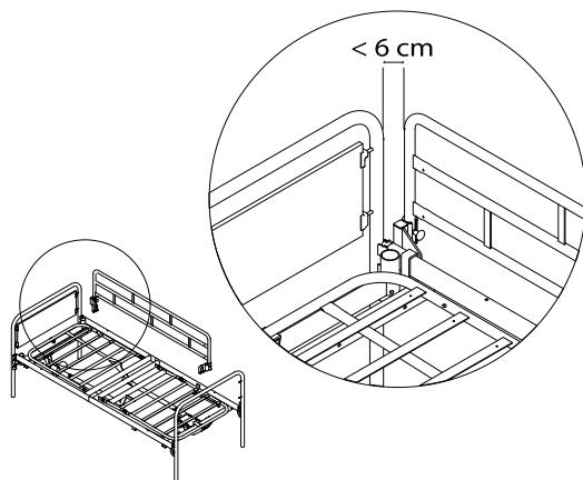
Abbassare la sponda laterale sull'attacco della gamba anteriore e serrare con la manopola.
