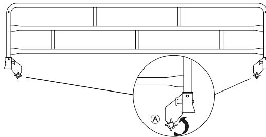
Afloje los tornillos de fijación A de los dos acoplamientos de la barandilla.
