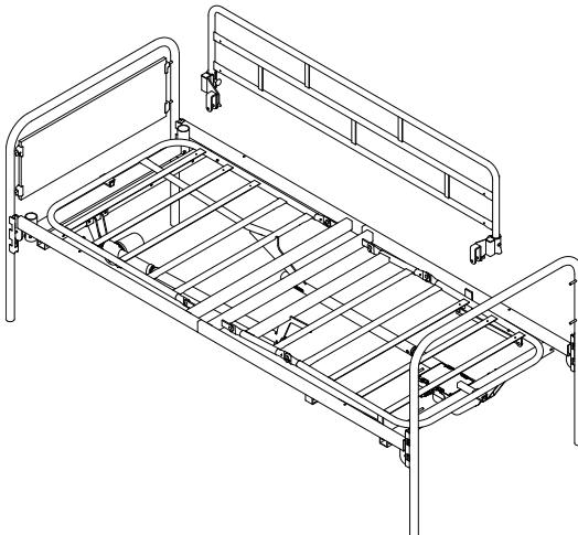
Coloque a guarda lateral no chassis próximo da cabeceira.
