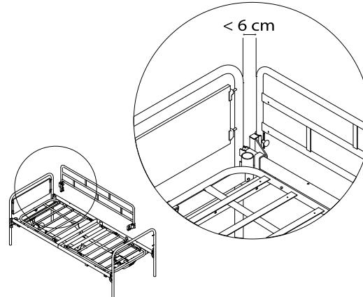
Baje la barandilla para colocarla sobre el acoplamiento de la pata delantera y apriétela con el tornillo de fijación.
