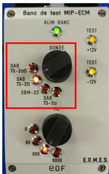
Sur les appareils MIP 10 numérique, MIP 21 et ECM 21, il est possible de brancher différentes sondes. Pour vérifier ces entrées, le banc de contrôle simule 4 sondes différentes : **SAB 70-2 $\alpha$  $\beta$** , **SAB 70-2 $\beta$** , **SBM-2D**, **SAB 70-2 $\alpha$** . Sélectionnez la sonde souhaitée à l'aide du commutateur. Le voyant correspondant doit s'allumer.
