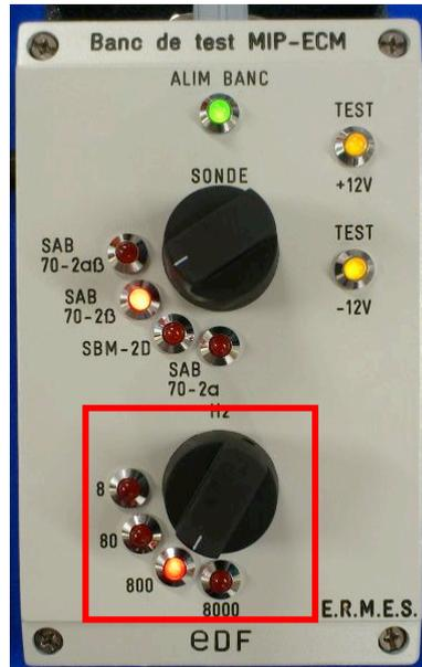
Le banc de contrôle permet de sélectionner 4 fréquences différentes. Pour cela tourner le commutateur sur la fréquence souhaitée. Le voyant correspondant doit s'allumer. Les 4 fréquences sélectionnables sont exprimées en **Hz** et sont de : **8Hz**, **80Hz**, **800Hz** et **8KHz**.
