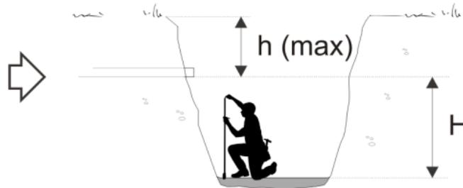
Figure 7-6: Profondeur de la fouille
