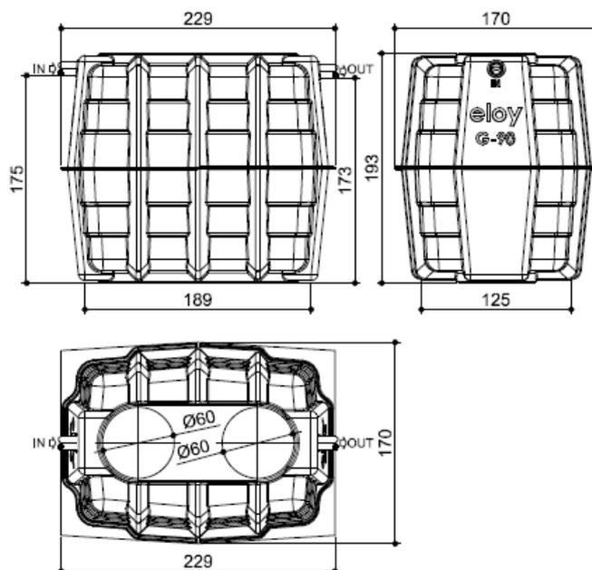
Figure 6-1: Plan d'encombrement de l'unité d'épuration Oxyfix® G-90 MB 4EH (1)
