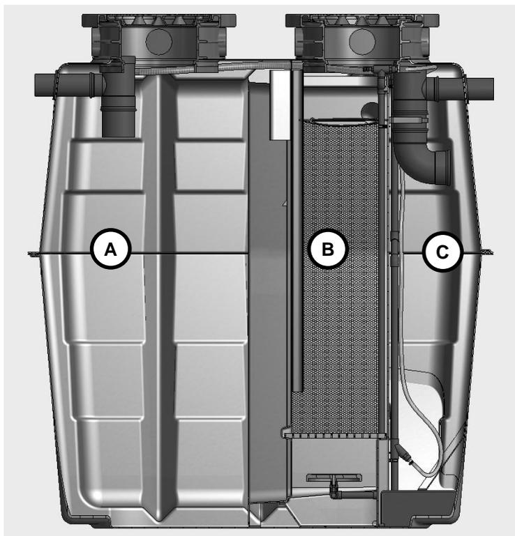
Figure 2-1. Schéma de principe de l'unité Oxyfix® G-90
