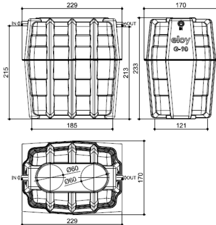
Figure 6-2: Plan d'encombrement de l'unité d'épuration Oxyfix® G-90 MB 5 et 6 EH.
