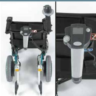
**Double commande intuitive à capteurs de pression (simple ou double) + Roulettes antibascule à démontage rapide Alber (option)**
