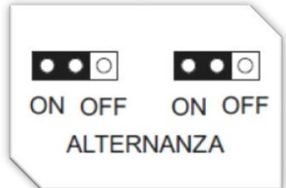
Pour activer la commande directe des moteurs, positionner les cavaliers ALTERNATION sur OFF.
