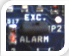
En positionnant le cavalier EXC. ALARM, l'ouverture du contact d'entrée G.MIN entraîne la signalisation lumineuse d'alarme de niveau à l'avant du tableau et la commutation du relais d'alarme cumulatif.
