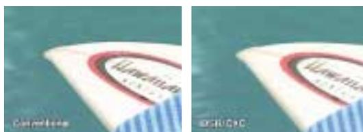
Le phénomène du "halo noir" apparaît entre deux zones sombres. Ce contraste excessif apparaissant sur le contour d'une zone est éliminé par la fonction DSP des caméscopes DVCAM.
