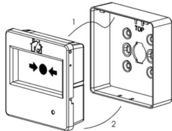
Une fois les câbles connectés, remontez le panneau frontal du déclencheur en l'introduisant dans le boîtier, d'abord la partie supérieure en l'inclinant et en faisant coïncider les languettes, puis en appuyant légèrement sur la partie inférieure.
