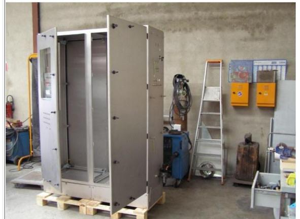
Armoires pour utilisation en zone 1/21 ou 2/22 livrées avec le système de purge et de pressurisation monté, câblé et testé. Armoire testée en purge et en compensation de fuite. Remise avec la déclaration d'examen CE de type, la déclaration de conformité ATEX et un manuel d'utilisation.
