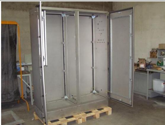
Armoires en acier inox 316L ou 304L microbillé, avec renfort de porte et panneaux et plaque passe câble démontables
