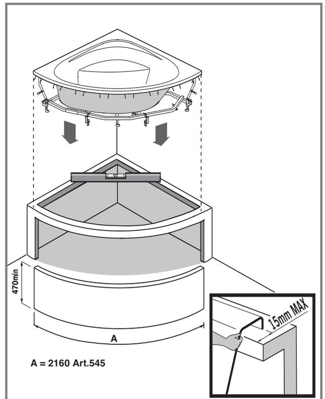
**Il est obligatoire de réaliser un PANNEAU AMOVIBLE À L'AVANT DE LA BAIGNOIRE** pour permettre l'inspection et pour la ventilation du circuit d'hydromassage.
