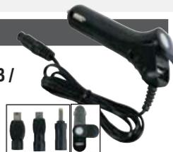
**Caractéristiques techniques :** Tension d'entrée : 12 à 24V (allume-cigare) - Tensions de sortie : 5V - Courant : 1A max - Protection contre les surcharges et les courts-circuits - Témoin d'alimentation par LED bleue - Dimensions : Diam. 20x110mm - Poids : 50g - Livré avec adaptateur : Micro USB / Mini USB / Fiche 4 x 1,7mm
