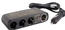
**Caractéristiques techniques :** Sortie : 3x12V (max. 10A de courant total) - Protection par fusible : 10A - Avec testeur de tensions à 3 LEDs - Indicateur de charge de la batterie par LEDs - Longueur du câble : 1.5m
