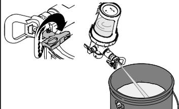
7. Verrouillez la gâchette. LEVEZ la vanne d'amorçage/de décompression. Dévissez la buse/ garde hors du pulvérisateur et plongez l'ensemble dans du liquide de rinçage. Retirez le réservoir et débarrassez-vous du liquide de manière appropriée.
