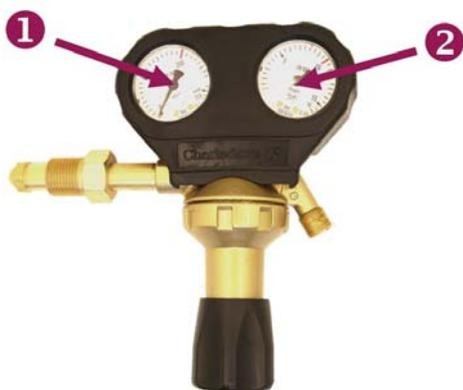
Le manomètre de gauche (❶) indique la pression en oxygène de la bouteille. Il permet de suivre la quantité de gaz consommée, la pression étant de 200 bars pour une bouteille pleine et diminuant au fur et à mesure, jusqu'à 0 lorsque celle-ci est vide.
