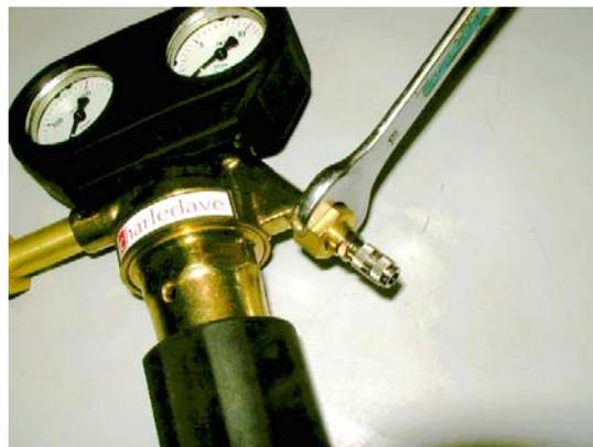
La sortie doit être vissée fermement à l'aide d'une clé pour que le raccord soit bien hermétique.
