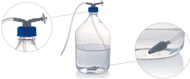
Les tubulures se fixent facilement à un préparateur de milieux, une bouteille ou une poche de diluant. Du stockage à la distribution, le circuit est entièrement fermé et sécurisé (pas de contaminations croisées). Elles sont entièrement autoclavables et amovibles sans outils.
