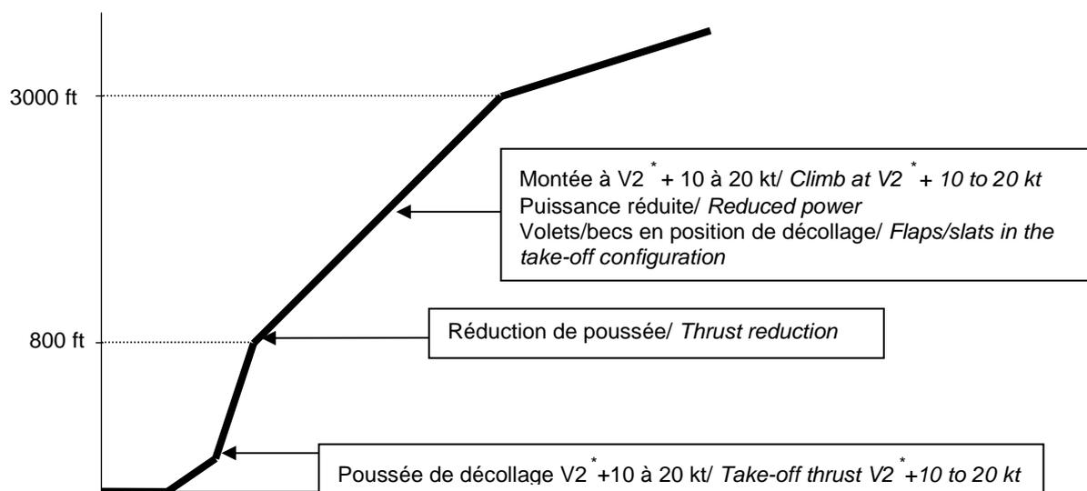
\* V2 est spécifiée dans le manuel d'utilisation de l'avion/ \* V2 is specified in the aircraft operating manual
