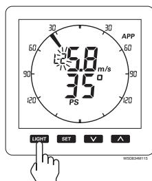
Door één of meerdere keren op de **LIGHT** toets te drukken kan de waarde van de schaalverlichting (**L0** - **L5**) worden gewijzigd.
