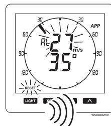
Der Alarm kann unterdrückt werden, indem man die **LIGHT (RESET)**-Taste drückt.
