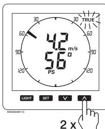
**Parametro indicato correttamente se è nota la velocità di crociera ed il relativo segnale viene trasmesso correttamente allo strumento. **TRUE** lampeggia per 5 sec., quindi resta visualizzato sul display.**
