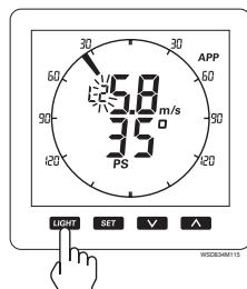
Premendo una o più volte il pulsante **LIGHT** l'intensità di illuminazione della scala (**L0 - L5**) viene modificata.
