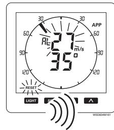
Het alarm kan worden onderdrukt door op de **LIGHT (RESET)** toets te drukken.
