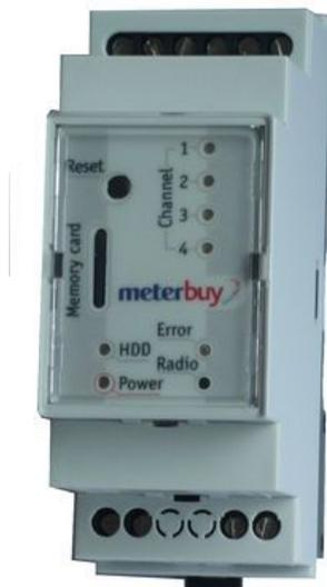
Le module EnergyLog est un enregistreur de données avec interface S0, qui enregistre les impulsions et les retranscrit sur une carte mémoire de type SD. Il peut être raccordé à tout réseau ou routeur grâce à une interface Ethernet. Il acquiert son adresse IP par DHCP, ce qui lui permet d'être configuré pour être accessible sur un réseau ou sur Internet en quelques minutes.
