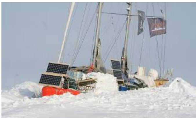
Photographie 17 : Panneaux solaires sur Bâbord et sur le nez du bateau. (© Tara Expéditions - Grant Redvers).
