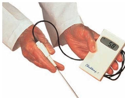
Thermomètre avec sonde à distance en acier inoxydable, longueur du fil : 1m.
