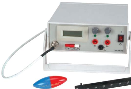
Ce teslamètre numérique permet aux élèves d'incorporer des mesures quantitatives à leurs expériences sur le magnétisme. La sonde à effet Hall fournie permet de mesurer les champs magnétiques axiaux et radiaux jusqu'à 200mT. Elle est de plus graduée jusqu'à 26cm.
