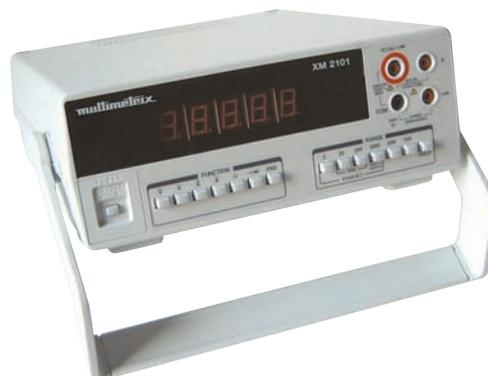
Un clavier de 7 touches permet de sélectionner le mode de changement de gammes :
