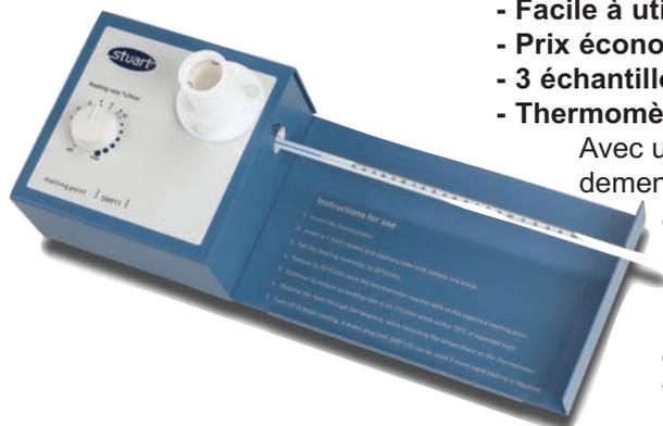
Avec un taux de chauffage réglable manuellement, le SMP11 chauffe rapidement des échantillons jusqu'à la température de fusion.
