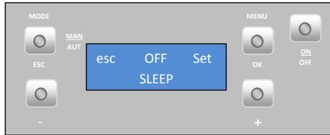
Appuyez sur "set": l'heure commence à clignoter. En utilisant les touches "-" et "+", il est possible de choisir l'heure souhaitée. Après avoir choisi l'heure, appuyez sur "ok" pour confirmer. Appuyez sur "esc" (échap) pour revenir au menu et sur "+" pour accéder au menu configurações (configuration).
