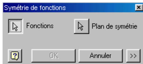
Pour une pièce symétrique, il suffit alors de dessiner la moitié de la pièce et de la dupliquer par le plan de symétrie.
