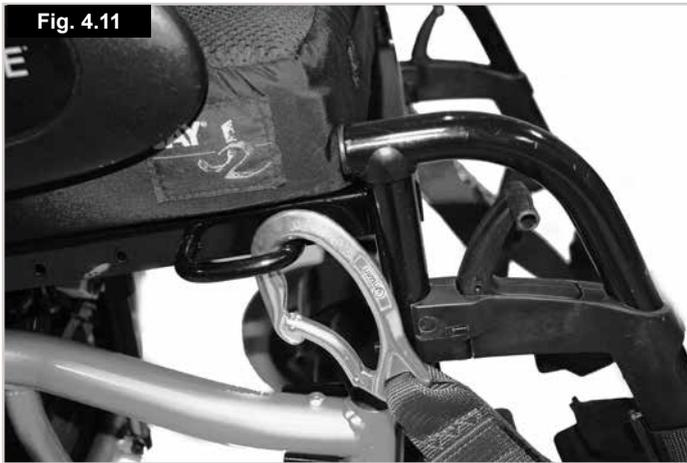
Positionnement du système d'arrimage avant, (Fig. 4.11).
