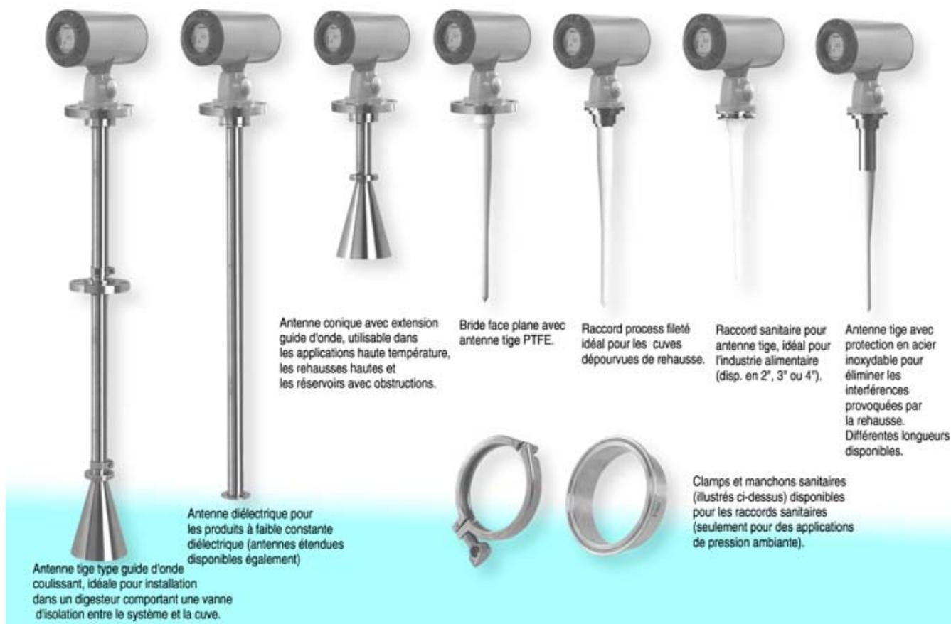
Fig. 4/79 Configurations d'antenne pour le SITRANS LR 300
