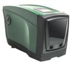
L'E.sybox est constitué d'une pompe auto-amorçante multicellulaire, d'un régulateur de fréquence, d'un capteur de pression et d'un capteur de débit, d'un écran LCD haute résolution et d'un vase d'expansions de 2L. Installation horizontale ou verticale. Silencieux avec seulement 45dB pour usage normal/
