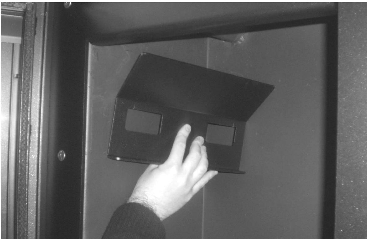
Retirez et nettoyez les deux supports pare-flamme latéraux et toute la partie au-dessus de la chambre de combustion.
