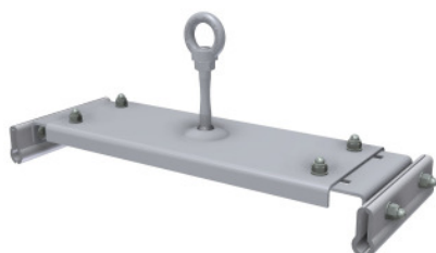
Afb.3: variant voor profielplatendaken (variabel van 480 tot 610 mm felsafstand)
