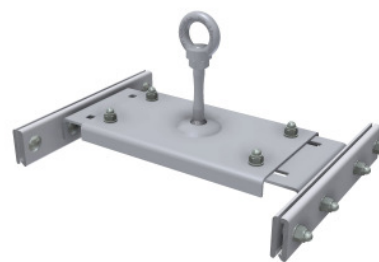
Fig. 2 : variante pour fixation par crabotage double sur joint debout (pour largeur de bande variable de 330 à 460 mm)
