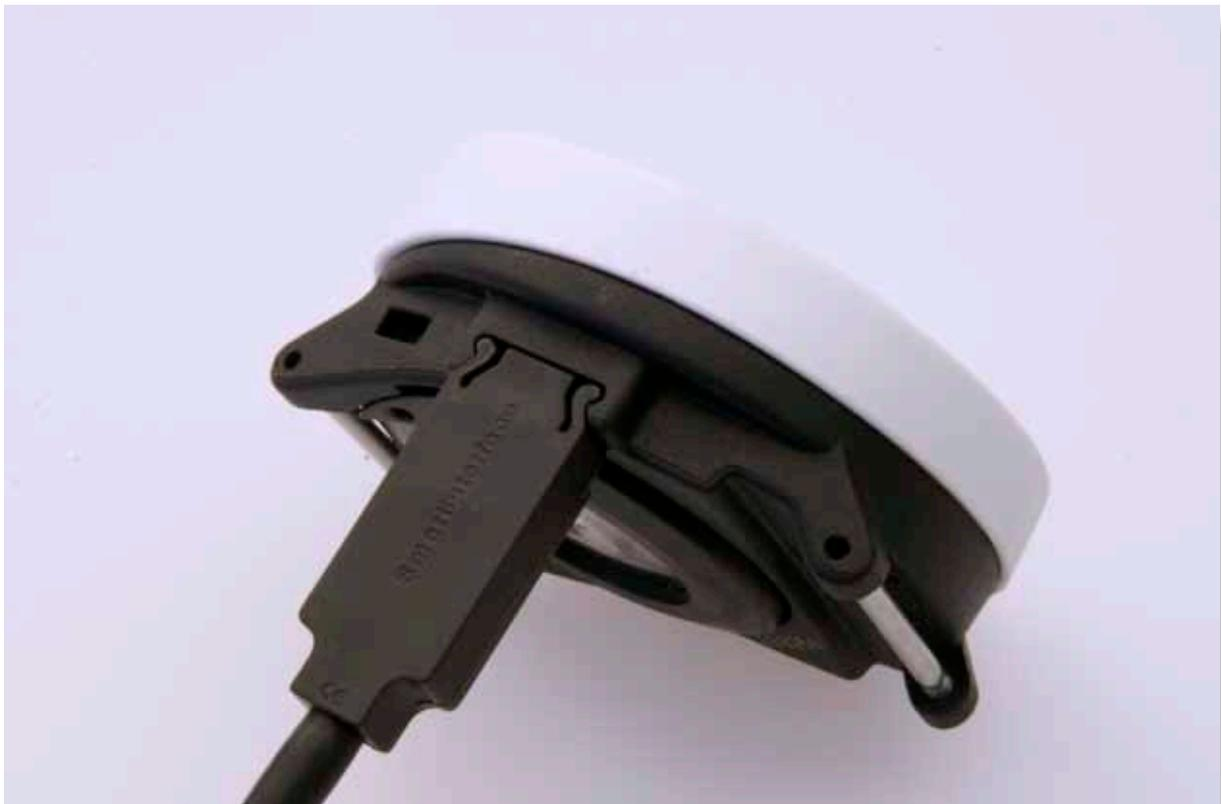
4.1 Le connecteur est protégé contre les inversions de polarité. L'encliquetage se fait par un léger appui sur l'ordinateur de plongée.
