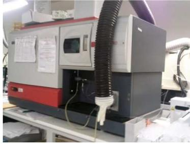
Figure 22 : Photographie d'un appareil ICP-AES Vista Pro de la société Varian
