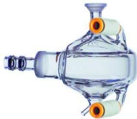
Figure 7 : Photographie d'une chambre cyclonique [HORIBA JOBIN YVON]
