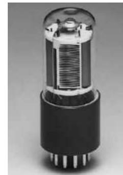
Figure 18 : Photographie d'un tube photomultiplicateur [DESBOEUF]
