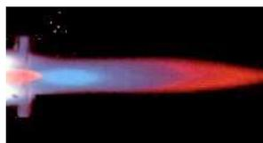
Figure 2 : Photographie d'un plasma\* d'argon [New Mexico State University]
