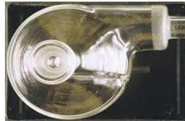
Figure 8 : Photographie d'une chambre à rotation verticale [HORIBA JOBIN YVON]
