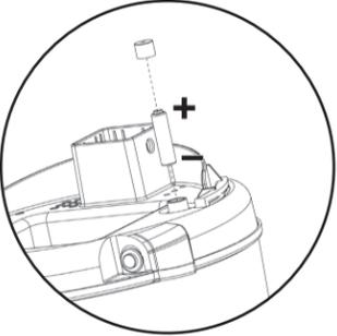
5. Fixez le capuchon en tournant dans le sens des aiguilles d'une montre jusqu'à ce qu'il se bloque.
