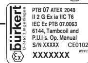
Fig. 1 : Exemple de plaque signalétique pour soupapes simple et double, type 6144
