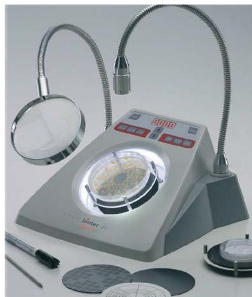
Utilisable avec une pointe de stylo ; la pression exercée sur la boîte de Petri déclenche le comptage et effectue l'incrémentation de 0 à 9999.
