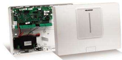
La centrale MP508TG/EN contrôle la totalité du système, en recevant et en élaborant les informations qui parviennent des périphériques connectés via bus active lorsqu'il est nécessaire les dispositifs et les communications d'alarme. Elle est en mesure de gérer séparément les signalisations relatives aux différents types d'événement: tentatives d'intrusion, tentatives de sabotage, alarmes techniques (par exemple, inondation). La centrale gère jusqu'à 8 secteurs différents.
