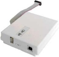
L'interface IT-USB/KEY permet de connecter à la centrale MP508TG/EN un ordinateur à pour la programmer.
