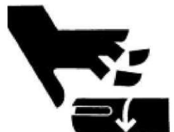
Essuyez l'excédent d'huile côté évacuation. Un excédent d'huile risque d'endommager le joint torique et peut s'accumuler au niveau des aubes du moteur.
