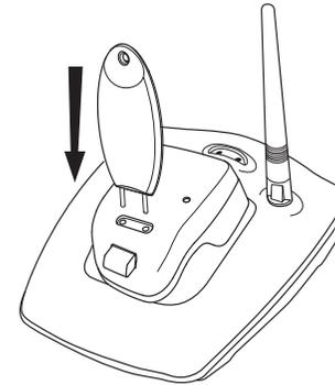
Si le mécanisme est enfoncé correctement, le témoin rouge du chargeur s'allumera pour signifier qu'une recharge est en cours. Le témoin rouge s'éteint lorsque la recharge est complétée. Le processus de charge prend environ deux heures.
