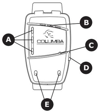
A. Contacts électriques permettant d'effectuer la recharge avec le bloc-batterie.
