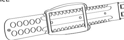
Cette étape complétée, il faut ensuite fixer la serrure à l'extrémité perforée du bracelet en utilisant le tournevis inclus dans l'emballage. La serrure doit être vissée au niveau des perforations précédemment identifiées.
