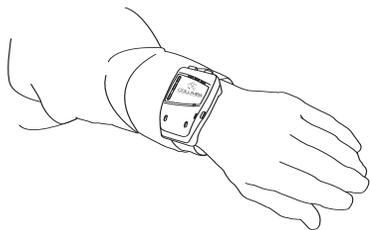
Installez ensuite le bracelet comportant le Columba<sup>MC</sup> autour du poignet du porteur et identifiez les orifices du bracelet dans lesquels il faut visser en place la serrure. Les orifices doivent être choisis pour ne pas permettre que le porteur puisse enlever le bracelet sans déverrouiller la serrure, tout en laissant un confort suffisant pour ne pas entraver la circulation ou causer d'inconfort. **NE SERREZ PAS TROP LE BRACELET POUR ÉVITER UN RISQUE DE BLESSURE.**
