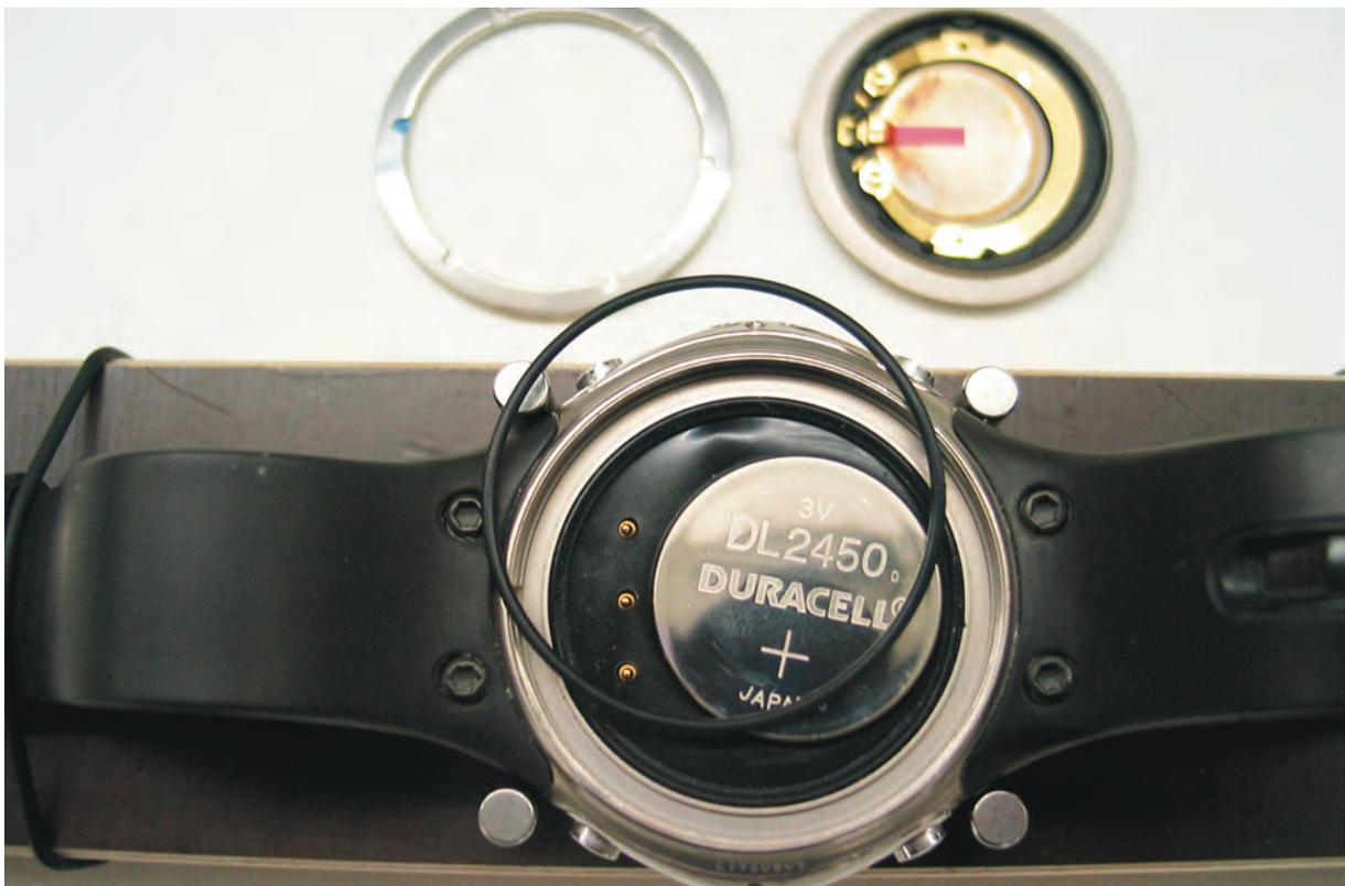
3.1 Enlevez le joint torique usagé ne pas utiliser d'outil, simplement en soufflant de coté sur le joint. Jetez le joint torique. (Important! il ne devra pas être réutilisé)
