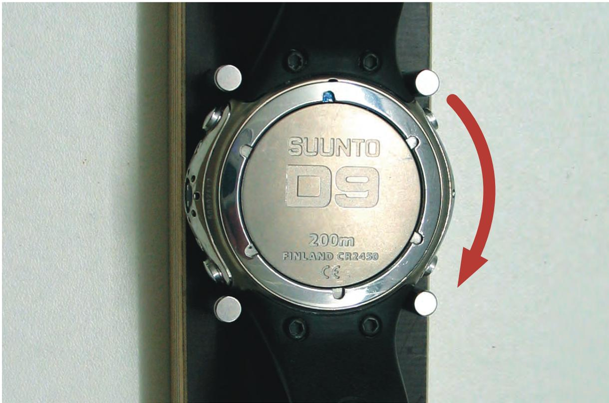
5.0 Placez l'écrou sur le fond du boîtier de la montre. Commencez par visser l'écrou à la main sens Horaire.
