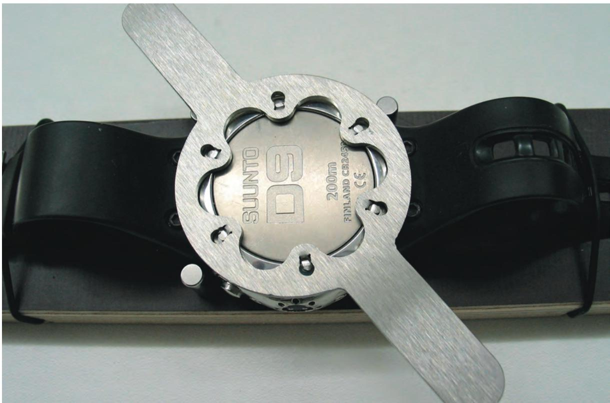
5.1 Insérez la clé sur l'écrou du fond de boîtier, les dents doivent s'emboîter et la clé doit être bien horizontale.
