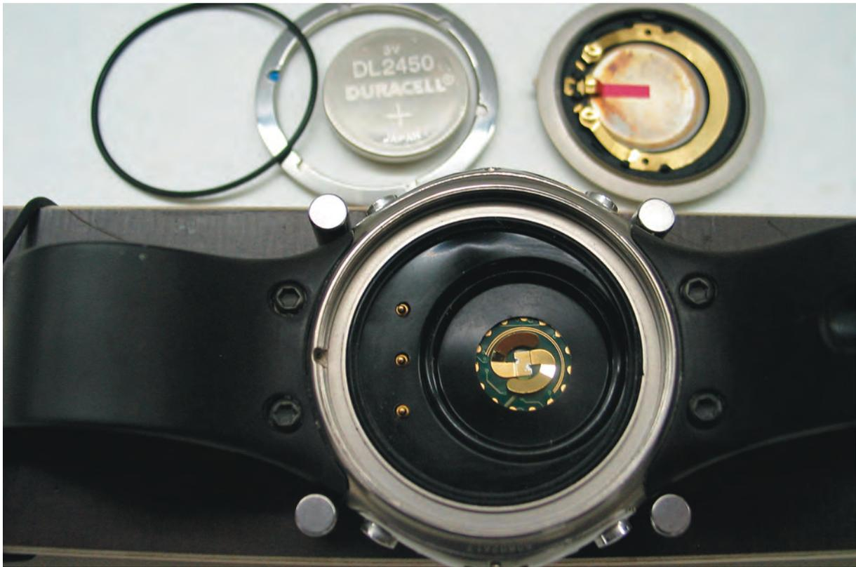
3.2 Enlevez la pile, ne pas utiliser d'outil, jetez la pile dans un point de collecte pour recyclage. Nettoyer la gorge circulaire du joint torique avec la pointe d'un tissu sec, ne pas utiliser d'outil.
