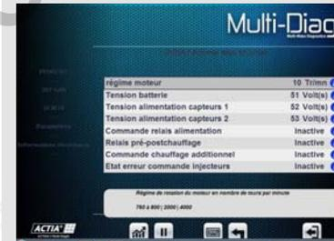
Visualiser l'ensemble des paramètres gérés par le calculateur.
