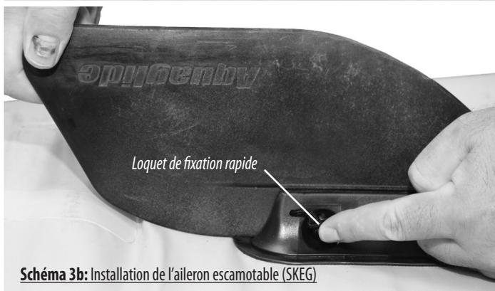
Schéma 3b: Installation de l'aileron escamotable (SKEG)
