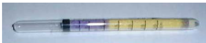
Photo 7 : Coloration du tube Dräger pour l'ammoniac
