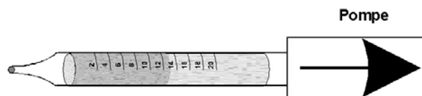
Figure 1 : Principe d'utilisation des tubes à indication colorée
