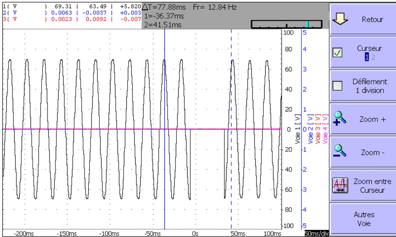
Il est possible de déclencher sur un parasite d'un signal périodique 50 Hz : on déclenche lorsque le signal change de forme radicalement :
