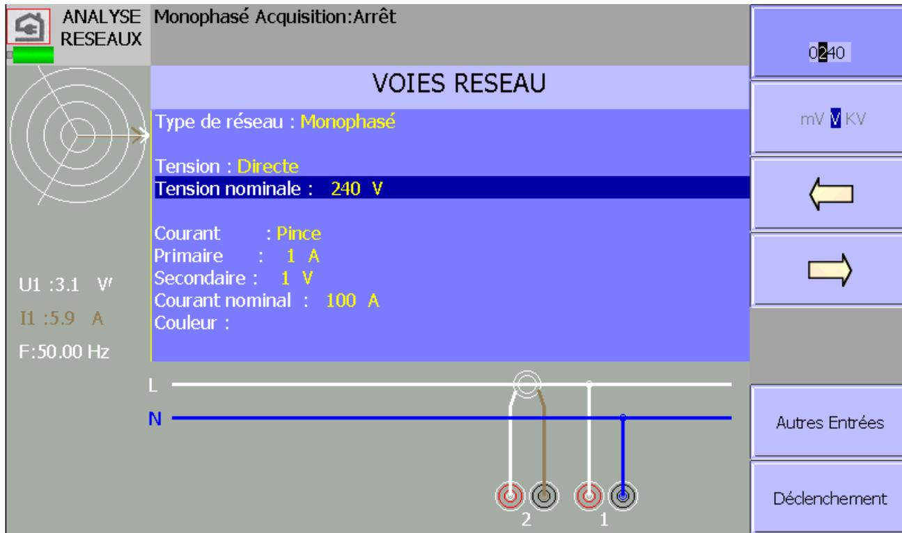
On choisit la configuration de base du réseau utilisé.
