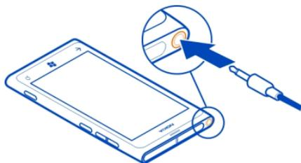
Ne connectez pas de produit créant un signal de sortie, car cela pourrait endommager l'appareil. Ne raccordez aucune source de tension au connecteur audio. Si vous connectez au connecteur audio un appareil externe ou un kit oreillette autre que ceux dont l'utilisation avec cet appareil a été agréée par Nokia, faites particulièrement attention au niveau du volume.
