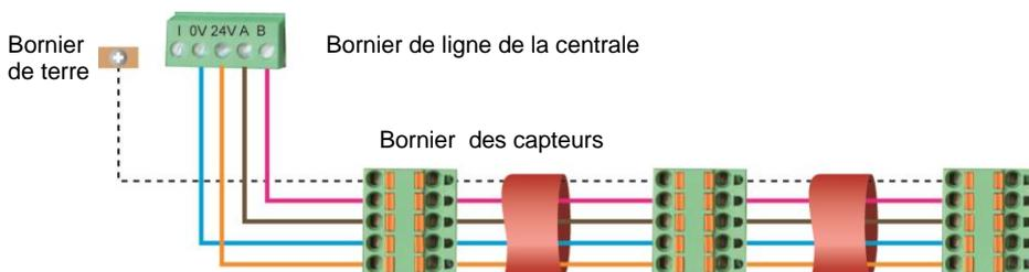
Figure 3 : principe de connexion des modules d'une ligne de la MX 43
