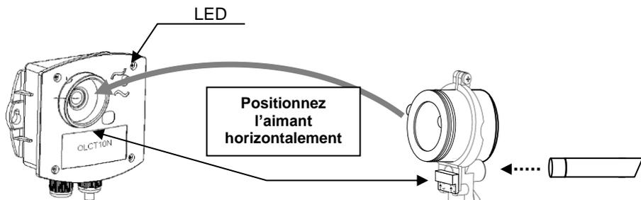
Le dispositif de calibrage équipé de son aimant permet d'effectuer le calibrage du capteur sans ouvrir le boîtier ; **cela permet un gain de temps considérable.**
