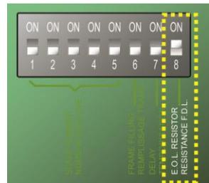
Figure 5 : interrupteur de résistance de fin de ligne en position « ON »
