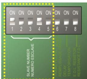
**Figure 4 : interrupteurs de configuration d'adresse**
