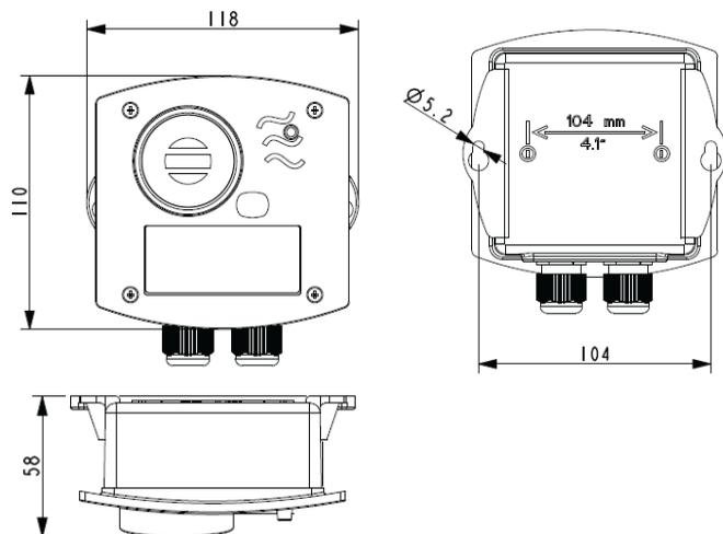
Figure 2 : Encombrement de l'OLCT 10N (en mm)
