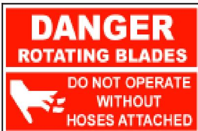
Le souffleur en rotation risque d'être dangereux ! Les vêtements amples, les cheveux, les mains, etc. peuvent être aspirés dans la chambre de l'aspirateur. Bien fixer les flexibles avant la mise en fonctionnement. Dans le cas contraire, il y a un risque de blessures graves ou de mort.
