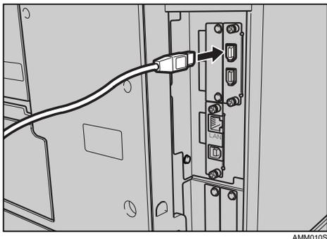
**2** Pour le raccordement de l'interface IEEE 1394 (impression SCSI), branchez l'autre extrémité du câble au connecteur de l'interface de l'ordinateur hôte.
