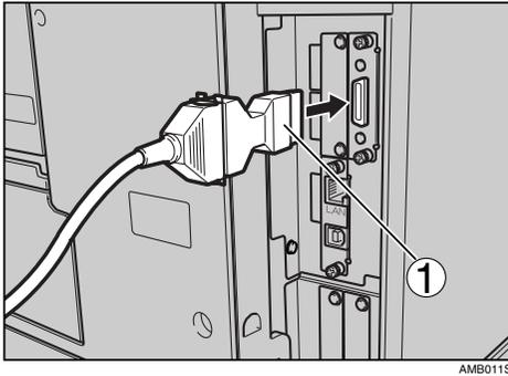
Pour le raccordement, utilisez le connecteur de conversion (1) fourni avec la carte d'interface IEEE 1284.
