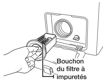
5. Retirez toute impureté et autre corps étranger pris dans le filtre et nettoyez ce dernier. Assurez-vous que l'hélice de la pompe de vidange située derrière le filtre n'est pas bloquée.
